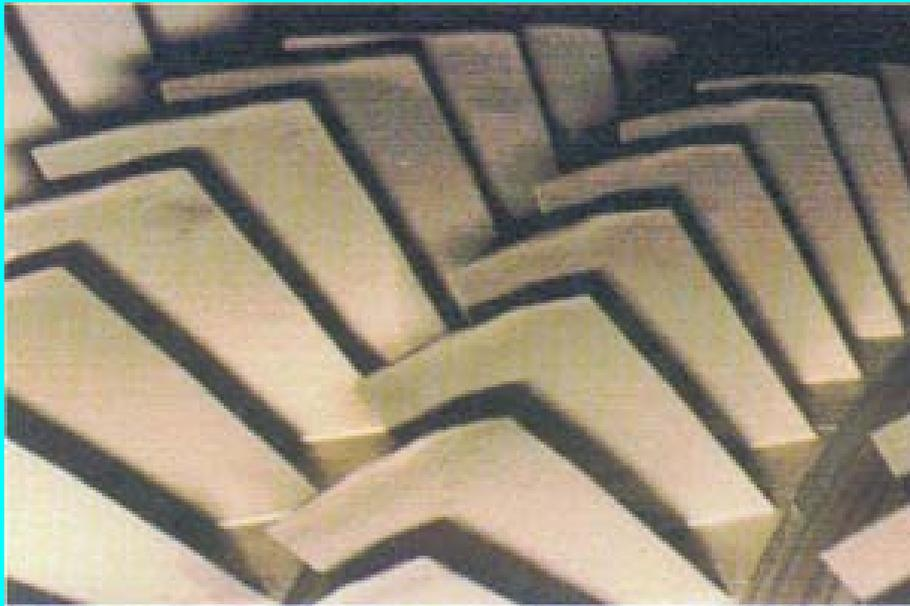
**Erosión en los álabes producida por ingestión de cenizas volcánicas.**
